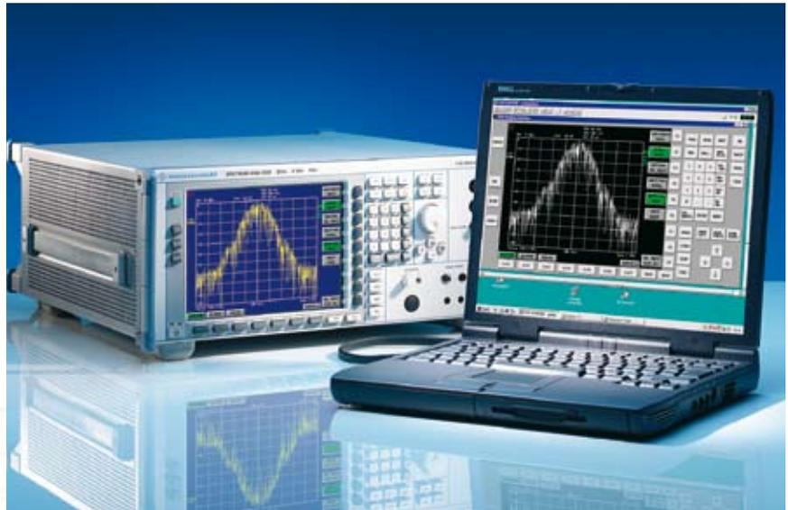
Ein sehr niedriger Eigenrauschpegel von typ.  $-148$  dBm bezogen auf 1 Hz Bandbreite bei 26 GHz und  $-138$  dBm (1 Hz) bei 46 GHz unterstützt genaue und empfindliche Messungen.
